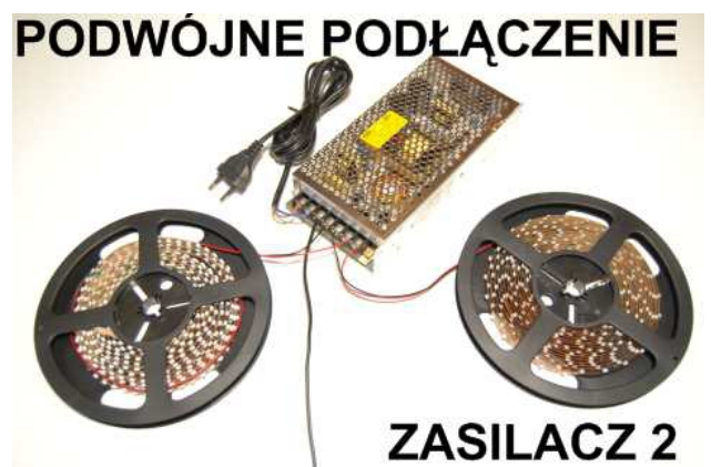
Podłączenie listwy LED do ZASILACZA 2 Podłączenie 2 taśm ROWNOLEGLE
