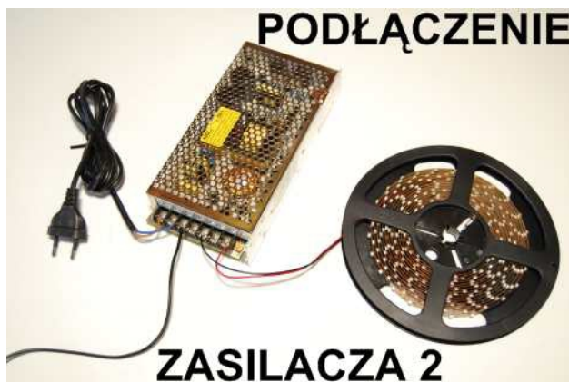
Podłączenie listwy LED do ZASILACZA 2
